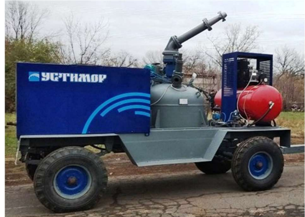
Рис. 7. Зовнішній вигляд установки імпульсного дрібнодисперсного зрошення «Устімор»
