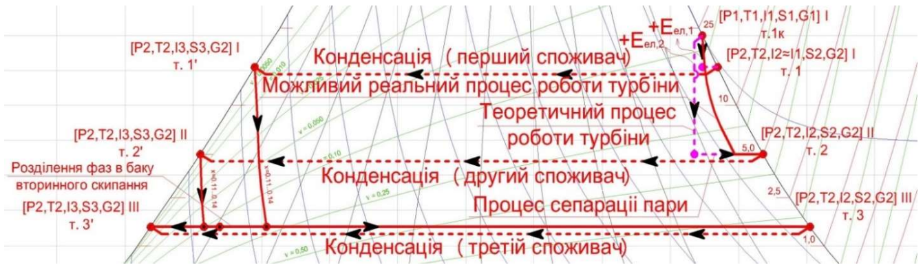
Рис.3. Фрагмент TS-діаграми води та водяної пари. Характерні термодинамічні процеси паралельної схеми паропостачання промислового підприємства з використанням динамічного потенціалу гострої насиченої пари
