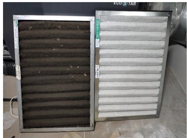
Рис.2. Брудний фільтр (термін використання 1 місяць) та чистий фільтр G4.
