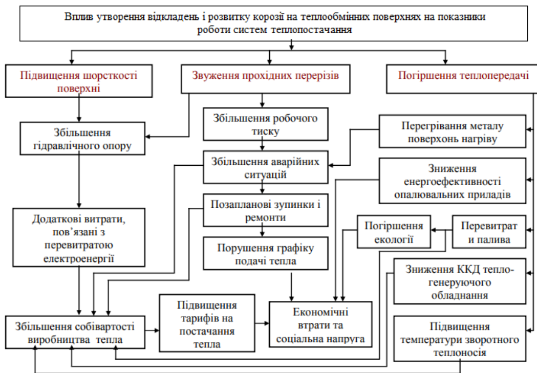
Рис.1 Вплив відкладень на роботу елементів систем теплопостачання
