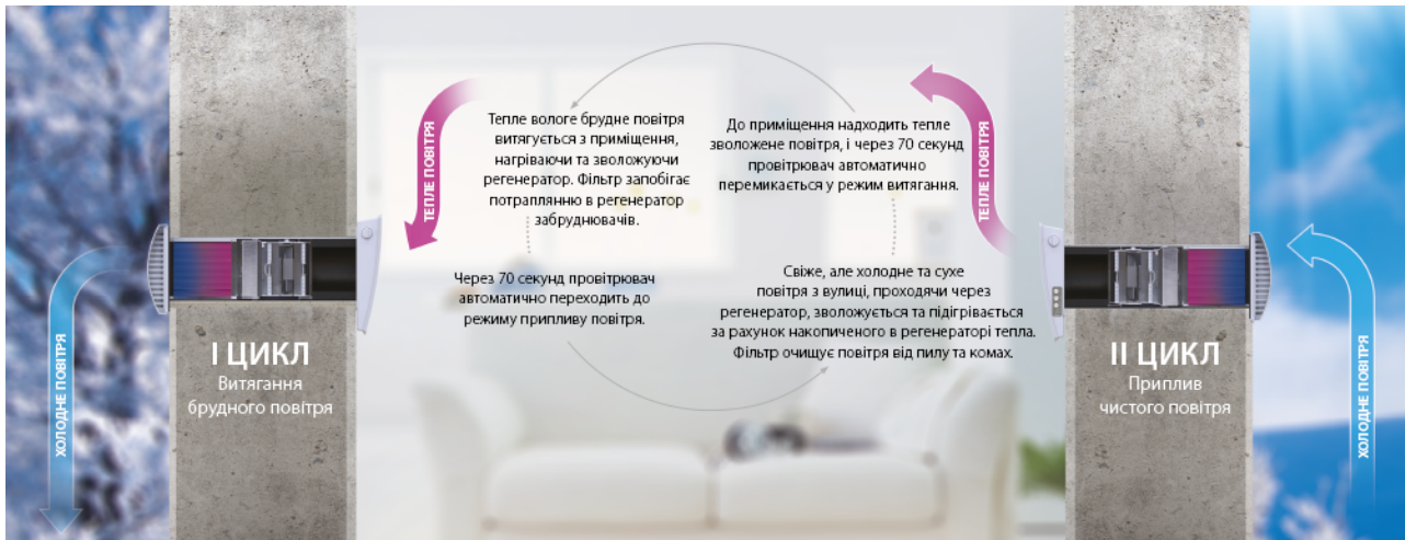
Рис. 1 Принцип роботи провітрювача Vents Twin Fresh [4]
