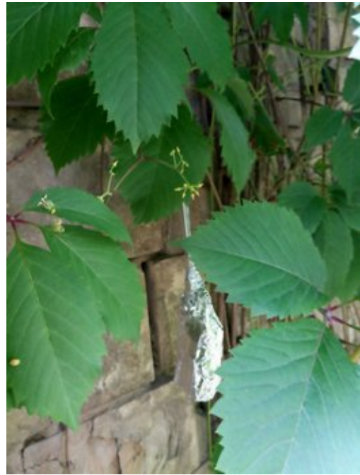
Рис.2. Розташування термометра для вимірювання температури під рослинним шаром вертикального озеленення з винограду дикого ( Parthenocissus )
