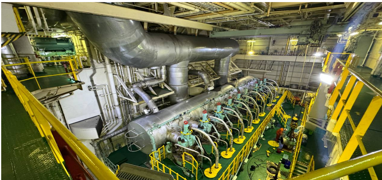
Рис. 2. Загальний вигляд машинного відділення судна: головний судновий двигун з термоізованим газовідвідним колектором, підключеним до системи очищення димових газів (скрубера).
