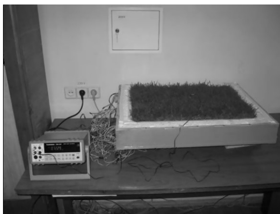
Рис. 1. Фізична модель екстенсивного зеленої покрівлі (за незначної швидкості повітря)
