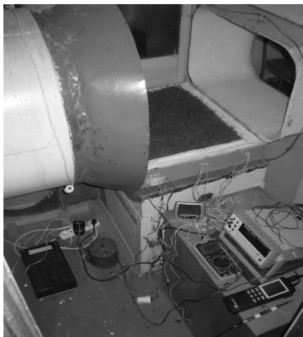
Рис.2. Фізична модель екстенсивної зеленої покрівлі (аеродинамічна труба)
